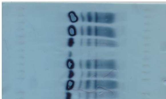
Кривизна дорожек. Пленка была плохо отжата фильтровальной бумагой. Не проводился префорез, участки имеют различную влажность. (Пунцовый S)
