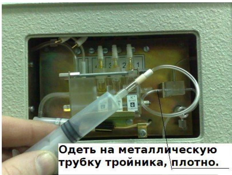
Нажимайте кнопку «Режим» до появления надписи на дисплее анализатора «Служебные программы», нажмите «Пуск», Нажимайте «Режим» до «Замена трубки клапана» и нажмите «Пуск».
