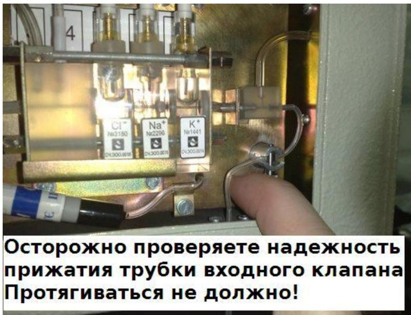
Осторожно проверяете надежность прижатия трубки входного клапана Протягиваться не должно!
