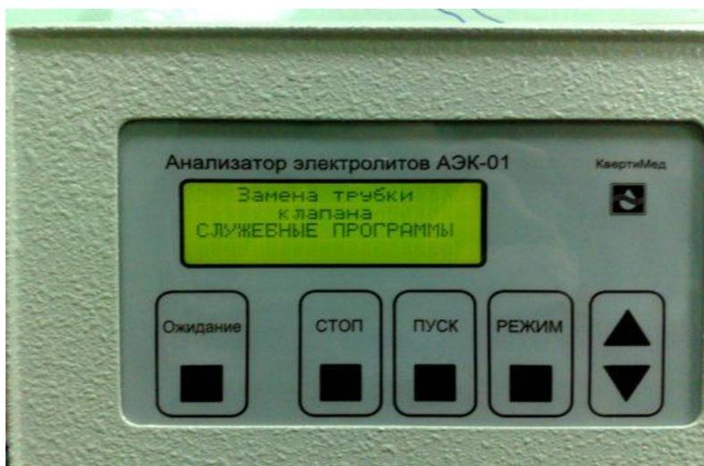
После появления сообщения «Идет замена трубки клапана» входной клапан срабатывает и освобождается трубка входного клапана.
