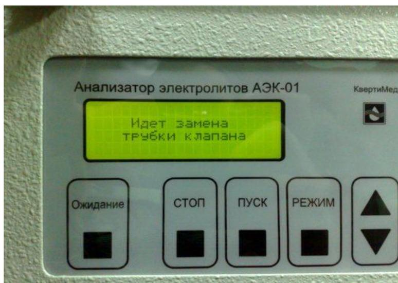
Открутите винт входного клапана и освободите трубку. Посмотрите на место прижима трубки, где могут часто образовываться засорения, которые мешают прохождению пробы. Внимательно проверьте отсутствие трещин или дыр в трубке входного клапана, где может подсасывать воздух и подтекать жидкости.
