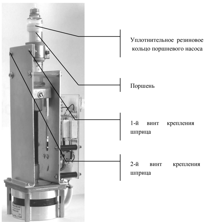
Рисунок 20 – Поршневой насос
