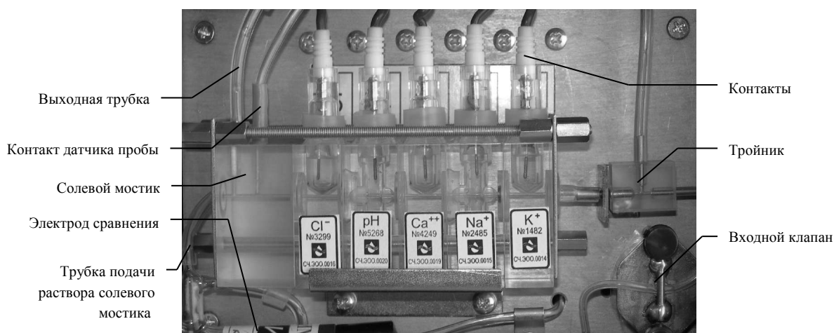
Рисунок 5б - Электродный блок со стеклянным электродом сравнения
