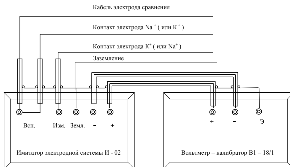
Рисунок 15- Схема установки для определения абсолютной погрешности измерительного преобразователя прибора
